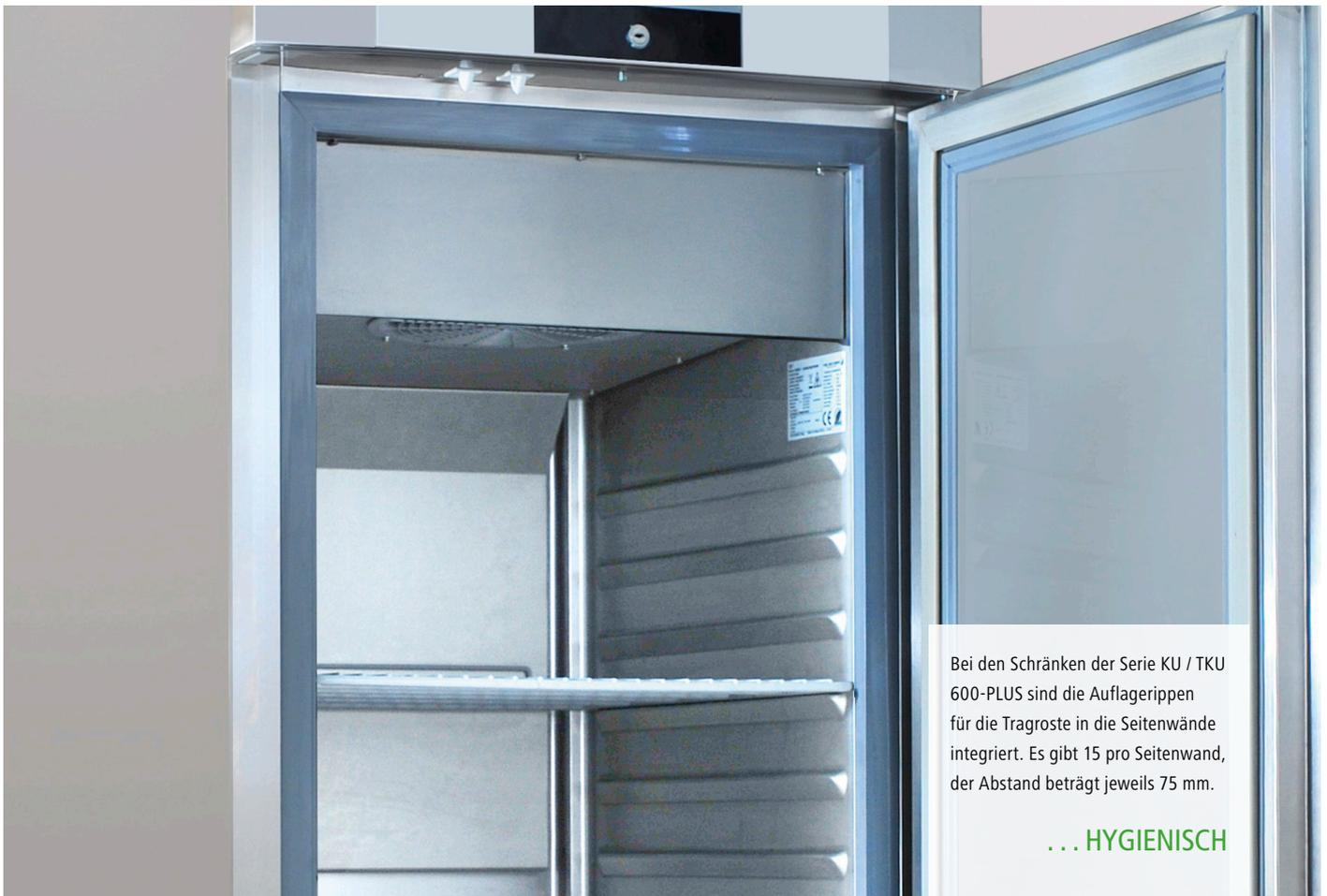
Bei den Schränken der Serie KU / TKU 600-PLUS sind die Auflagerippen für die Tragroste in die Seitenwände integriert. Es gibt 15 pro Seitenwand, der Abstand beträgt jeweils 75 mm.
