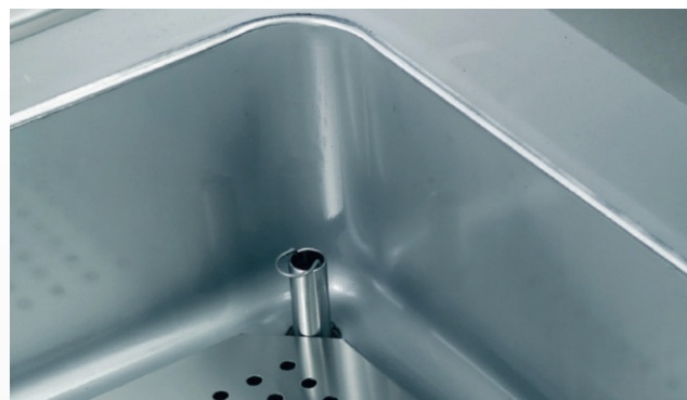
22-Liter-Becken aus Chromnickelstahl 1.4301 mit 15 mm Verbundbodenplatte – 12 mm Unterschicht aus Weichstahl in Verbindung mit einer 3 mm starken Deckschicht aus korrosionsbeständigem Chromnickel-Molybdänstahl 1.4401
