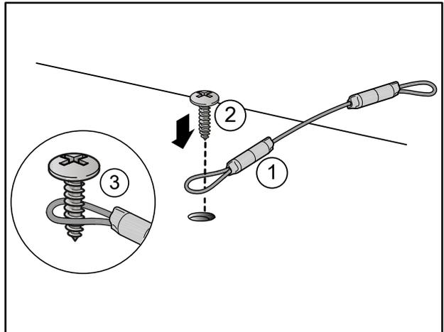
4. Drehen Sie die Schraube mit der Kabelschleife wieder in die Geräteabdeckung hinein.
