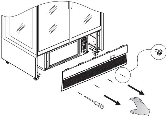
Lösen Sie die auf der Frontabdeckung angegebenen Schrauben und entfernen Sie diese.
