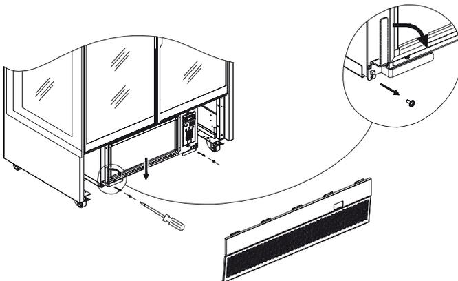
Entfernen Sie die Schrauben, welche die Griffe sichern.
