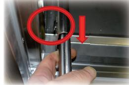
Ziehen Sie nun die innere Auszugsschiene ganz heraus, drehen sie leicht nach innen und ziehen sie nach oben, bis die Befestigungslasche aus der Führung gleitet. Sie können die Auszugsschiene nun nach vorn abziehen.
