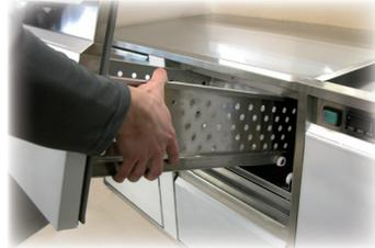
Ziehen Sie die Lade ganz bis auf Anschlag heraus. Heben Sie die Lade anschließend leicht an und ziehen Sie sie nach vorne aus der Führung heraus.
