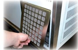
Lösen Sie die unterhalb des Griffs befindliche Schraube, schieben Sie den Fettfilter am Griff zuerst nach oben und ziehen ihn dann heraus. Der dahinterliegende Kondensator ist nach Erfordernis mit einem Pinsel oder Staubsauger mit geeignetem Bürstenaufsatz zu säubern. Gehen Sie beim Einsetzen des Filters in umgekehrter Reihenfolge vor.
