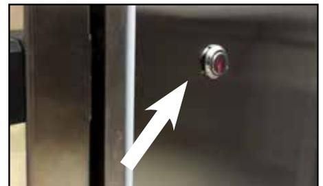
Den Schlüssel bis zum Anschlag in Uhrzeigersinn drehen. Zum Entriegeln der Tür den Schlüssel am Anschlag gedreht halten und gleichzeitig mit der anderen Hand den Handgriff drehen.
