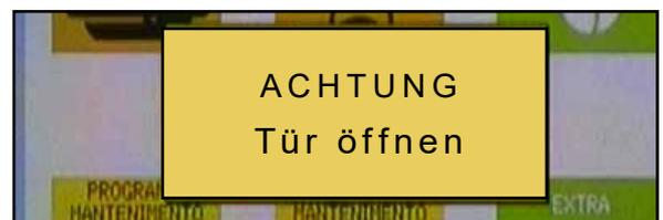
Wenn die Tür geöffnet ist wird der Abkühlvorgang automatisch gestartet und bringt die Temperatur in der Kammer auf 50°C.
