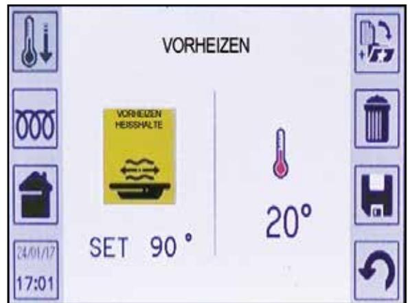
Mit dem Gerät im STOP-Zustand das Bildsymbol antippen. Der Bildschirm zeigt ein Pop-up-Fenster an. Zum Auswählen der gewünschten Temperatur (z.B. 80°C) den Drehknopf drehen und mit ENTER bestätigen oder erneut auf das Bildsymbol drücken.
