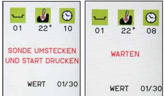
Setzen Sie die Sonde in den Kern des Produktes „START“. Vor der Messung besteht eine Verzögerungszeit von 10“.
