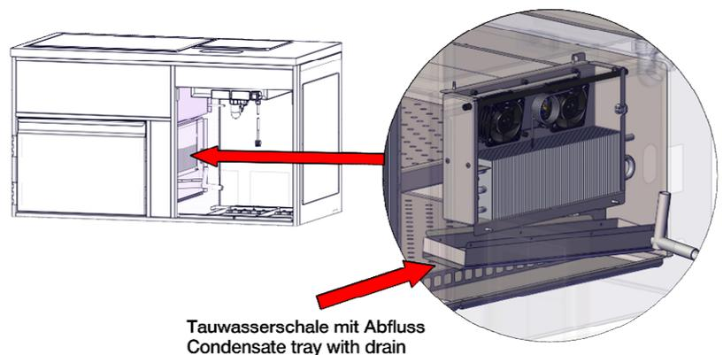
Abbildung 5: Tauwasseranschluss
