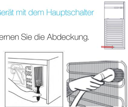
Abbildung 11: Kondensator reinigen
