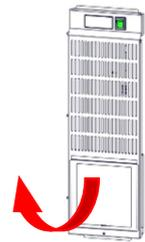
Abbildung 10: Reinigung Fettfilter
