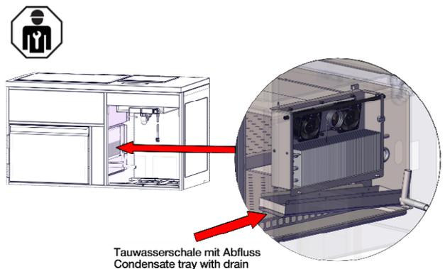
Abbildung 13: Position Verdampfer für Service
