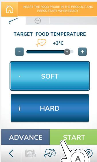
**A** Der Start des gerade eingerichteten Zyklus erfolgt durch Drücken der Taste **START**
