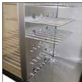
A2. Spostare verso sinistra 3 file di tondini oppure svitarli (dipende dai modelli)
