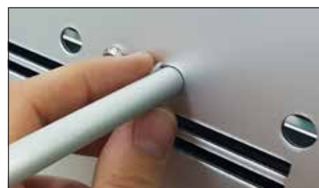
3. Dopo aver inserito totalmente il tondino, bloccare con la seconda clip di fermo nel vano sinistro.
