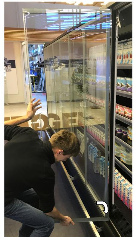
6) Die Tür angehoben halten und am unteren Zapfen einsetzen.
