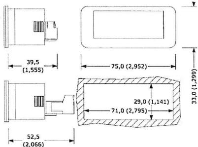
39,5 (1,555) ist die Tiefe mit fester geschraubter Klemmleiste. 52,5 (2,066) mit geschraubter Klemmleiste zum Herausnehmen.
