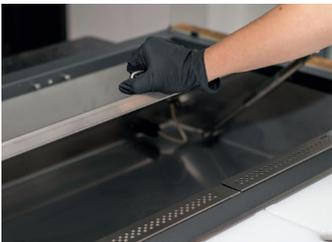
Heben Sie mit dem mittig angeordneten Griff von der Bedienseite aus die primäre Heizplatte an. Die Platte bleibt durch den Gasdruckdämpfer geöffnet. Dazu muss die Platte vollständig geöffnet sein!
