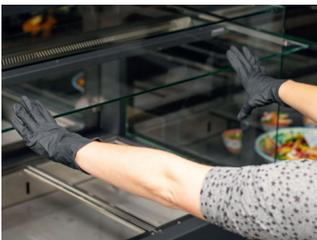
Heben Sie das Frontglas an und schieben Sie es, von eingebauten Schienen geführt, in die obere Endposition bis dieses einrastet.
