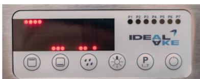
Nach dem Einschalten zeigt die Steuerung am Display immer die Leistungsstufe NEUTRAL für alle Wärmequellen an. Das Gerät heizt nicht auf. Das Licht kann an- und abgeschaltet werden. Durch Drücken der Tasten können Stützwärme **2**, Primärwärme **3** und Befeuchtung **4** in je 3 Stufen getrennt voneinander aktiviert werden. Am Steuerungsdisplay werden die Heizstufen visuell angezeigt.
