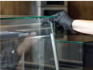
Drücken Sie mit einer Hand gegen eine der oberen Ecken des Frontglases, um die Unterkante einige Zentimeter nach außen zu schwingen.
