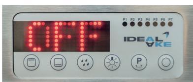
Wenn das Gerät an die Stromversorgung angeschlossen wurde, erscheint „OFF“ am Display.
