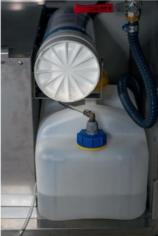
Verbinden Sie den Auslassschlauch der Bodenwanne mit dem Abfluss oder stellen Sie ein geeignetes Gefäß unter. Öffnen Sie den Kugelhahn und beginnen Sie mit der Reinigung. Nachdem die Bodenwanne gereinigt und mit klarem Wasser ausgespült wurde, schließen Sie den Kugelhahn und verstauen Sie den Auslassschlauch wieder im Unterbau.
