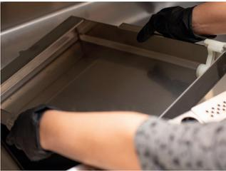
Entnehmen Sie das Wasserbad an den vorgesehenen Griffen. Entfernen Sie behutsam den Schwimmer und achten Sie darauf, diesen dabei nicht zu drehen. Die Halterungen könnten brechen! Reinigen Sie das Wasserbad erst nach Demontage des Schwimmers. Der Schwimmer darf ausschließlich von Hand gereinigt werden. Hier wird ein kalklösendes Reinigungsmittel empfohlen, welches für Edelstahl geeignet ist. Spülen Sie sämtliche Teile mit klarem Wasser, damit keine Rückstände bleiben.
