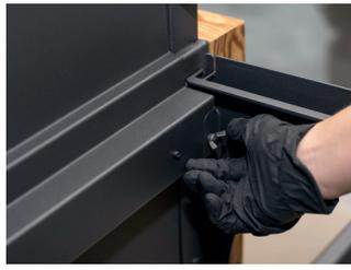
Lösen Sie die Flügelschraub auf der rechten Seite und entfernen Sie den freiwerdenden Winkel.
