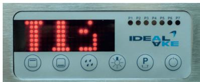
Stützwärme ② Stufe 3
