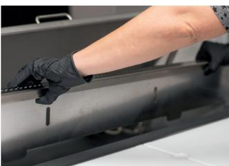
Entnehmen Sie das Dampfleitblech nach oben. Entnehmen Sie danach den herausnehmbaren Einfüllstutzen zur Reinigung.
