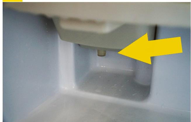
4a Entfernen Sie den Stutzen und lassen Sie das Wasser ab
