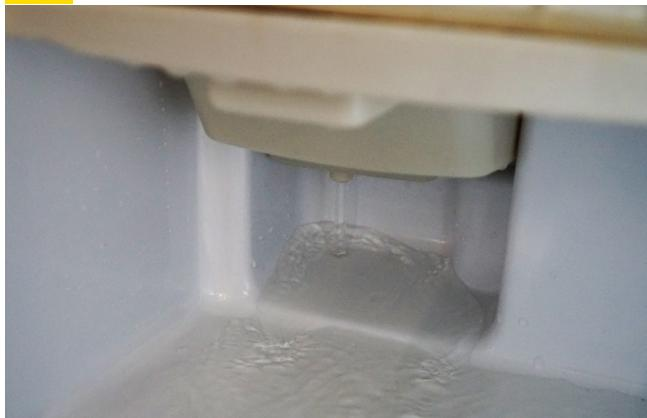
4b Entfernen Sie den Stutzen und lassen Sie das Wasser ab
