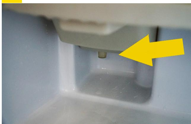
32a Entfernen Sie den Stutzen, lassen Sie das Desinfektionsmittel ab und setzen ihn dann wieder ein
