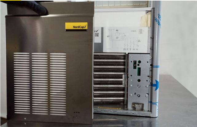
**9** Entfernen Sie die 4 Schrauben an der Oberseite
