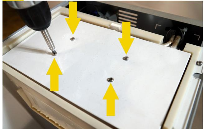
**9a** Entfernen Sie die 4 Schrauben an der Oberseite
