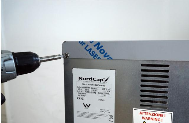
5a Entfernen Sie die 2 Schrauben an der Rückseite
