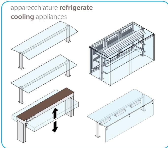
Die gekühlten **Geräte besitzen**, je nach Modell, vier verschiedene Typen von Aufsatz, alle mit der Möglichkeit der LED-Beleuchtung:
