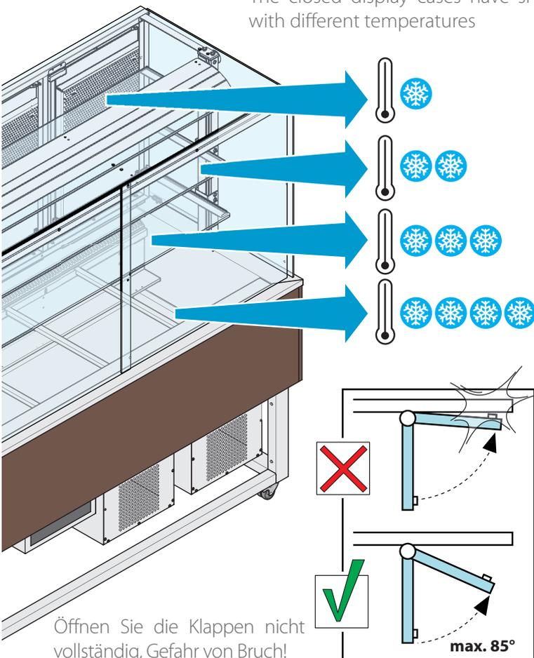
Öffnen Sie die Klappen nicht vollständig, Gefahr von Bruch!
