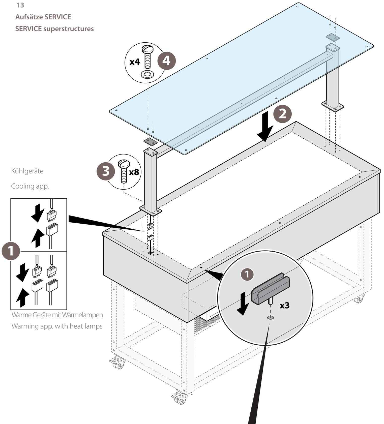
Wenn der Aufsatz später als das Gerät gekauft wird, sind diese Bohrungen nicht vorhanden und müssen daher vom Installateur vorgenommen werden. Bitten Sie in diesem Fall den Hersteller um eine Schablone, um sicherzugehen, dass sie korrekt gebohrt werden.
