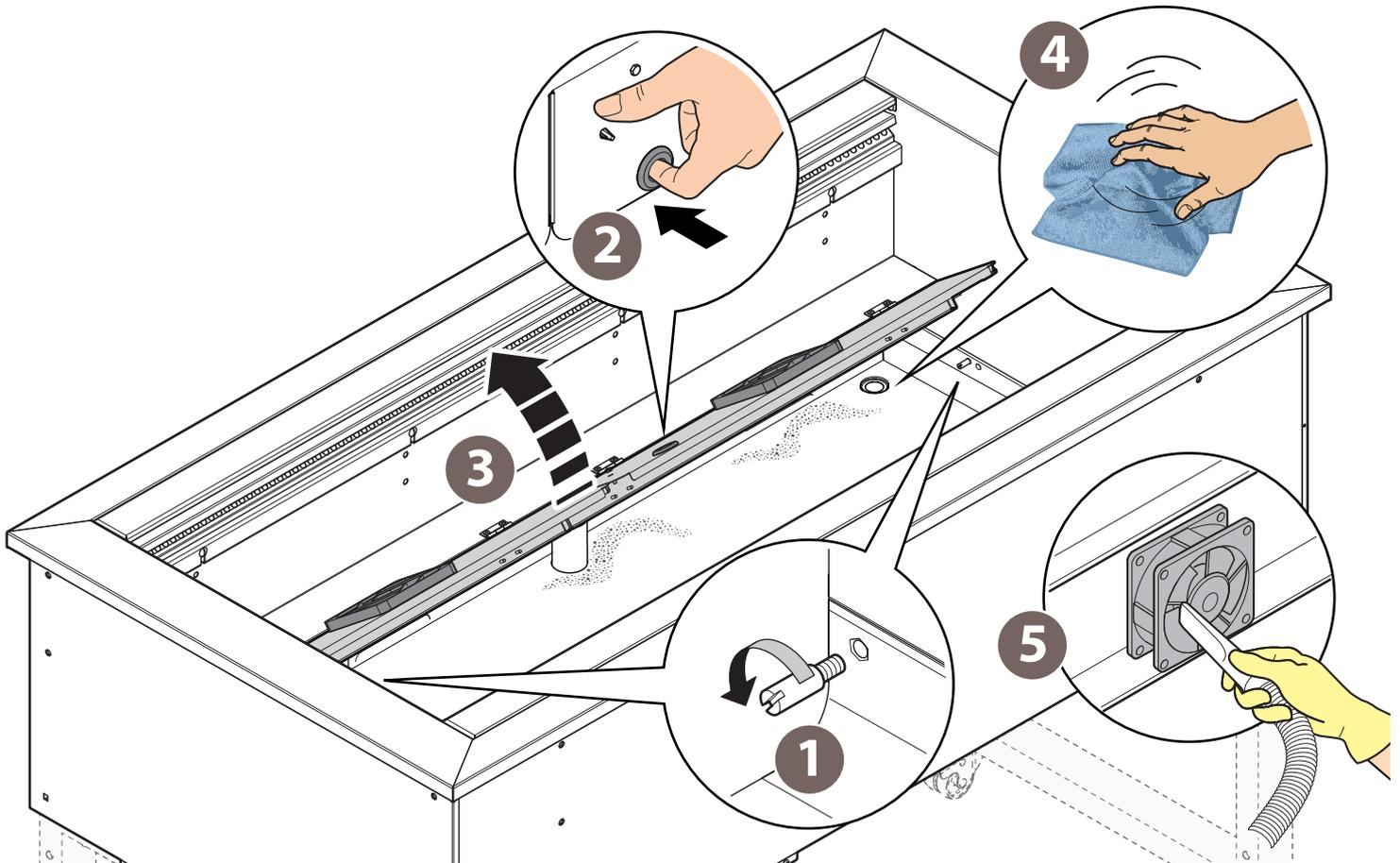
nur mit Wasser getränktes Tuch verwenden, wobei darauf zu achten ist, dass die Lampen nicht beschädigt oder an- gestoßen werden. Trocknen Sie alle Rückstände sorgfältig ab, um wärmebedingte Schäden an der Struktur zu vermeiden.
