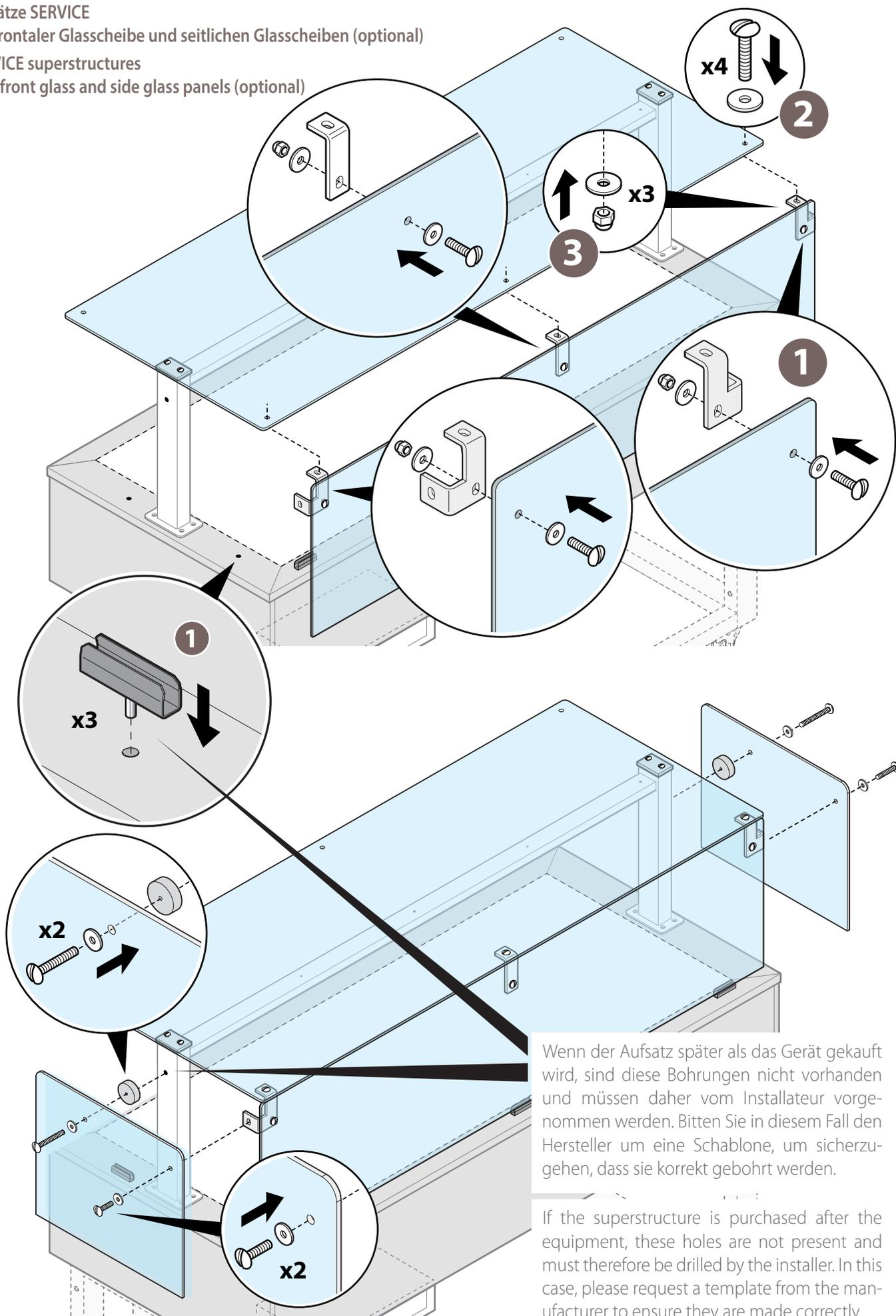
Wenn der Aufsatz später als das Gerät gekauft wird, sind diese Bohrungen nicht vorhanden und müssen daher vom Installateur vorgenommen werden. Bitte Sie in diesem Fall den Hersteller um eine Schablone, um sicherzugehen, dass sie korrekt gebohrt werden.
