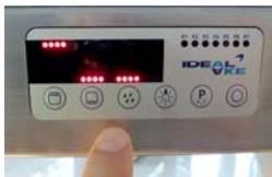
Nach dem Einschalten zeigt die Steuerung im Display immer die Leistungsstufe null für alle Wärmequellen an. Das Gerät heizt nicht auf.
