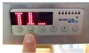
Durch das Betätigen des Druckknopfes
