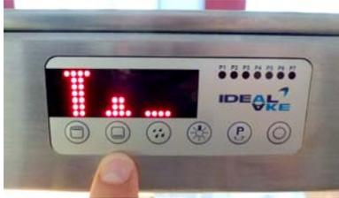
Die Vitrine verfügt über eine moderne, leistungsstarke und sehr leicht zu bedienende Steuerung. Das Display zeigt Ihnen alle Einstellungen und den Gerätezustand an. Sollte das Display nichts anzeigen, kann es sein, dass die Stromversorgung nicht intakt ist.
