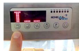
Durch das Betätigen des Druckknopfes
