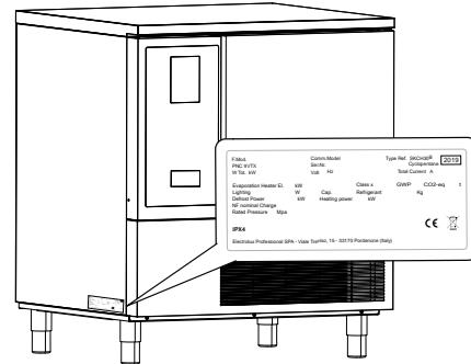
Bei den **20GN 1/1** Modellen ist das Typenschild im unteren Bereich auf der rechten Seite des Geräts angegeben. Das Schild nennt die Produktnummer des Geräts und ist oben am Gerät angebracht.
