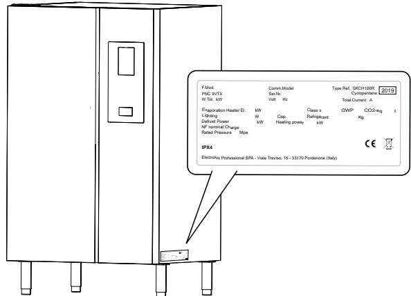
Bei den **20GN 2/1** Modellen ist das Typenschild im oberen Bereich auf der linken Seite des Geräts angegeben. Das Schild nennt die Produktnummer des Geräts und ist oben am Gerät angebracht.
