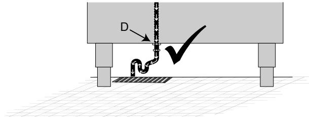
Bei den 6GN 1/1 — 10GN 1/1 — 10GN 2/1 Modellen beträgt der Durchmesser der Ablauföffnung  $1\frac{1}{2}$ ", daher sollte eine  $1\frac{1}{2}$ "-Ablaufleitung oder ein Schlauch mit 25 mm Durchmesser verwendet werden.
