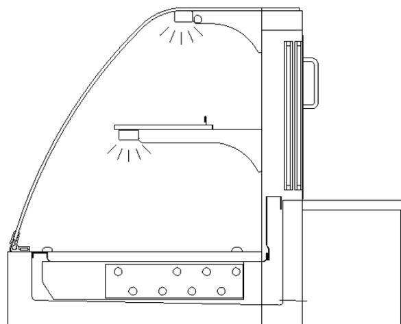
Steckerfertig oder für externen Kälteanschluss
