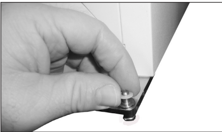
17. Die Kunststoff-Unterlegscheibe des Türzapfens auf der Unterseite entfernen.
