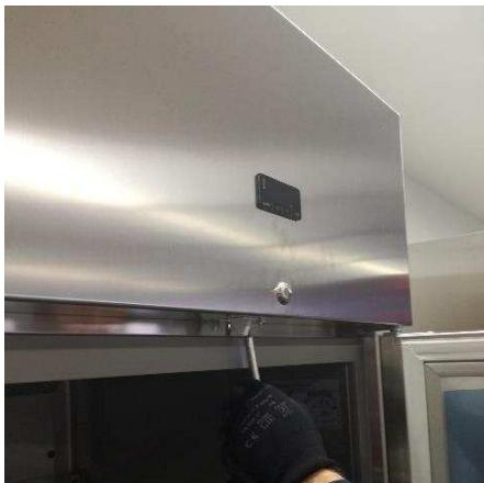
2. Die zwei Schrauben zur Befestigung des oberen Scharniers lösen.
