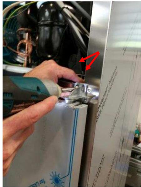
3. Die Tür entfernen und diese dazu vom unteren Scharnier anheben. Die beiden Schrauben für die Schließhalterung an der oberen Seite der Tür lösen.
