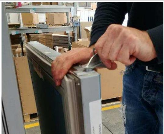
15. Das obere Scharnier am Chassis befestigen.
