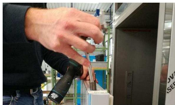
5. Das obere Scharnier mit einer Spitz'e Ø 7, wie in der Abbildung angezeigt, durchbohren, um die Bohrung links zu öffnen.
