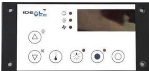
Bedienteil ist standardmäßig mit einem 1,5 m langen CAT5 Kabel mit der Leistungselektronik verbunden (bis max. 100 Meter).
