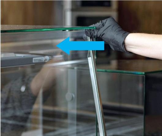
Drücken Sie mit einer Hand gegen eine der oberen Ecken des Frontglases, um die Unterkante einige Zentimeter nach außen zu drehen.
