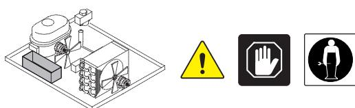
Die Reinigung muss je nach Gebrauch und Notwendigkeit und besonderen Umgebungsbedingungen (z.B. hohe Luftfeuchtigkeit, niedrige Umgebungstemperatur, Anwesenheit von Staub usw.) vorgenommen werden, um eine falsche und unvollkommene Verdampfung des Wassers und/oder die Anwesenheit von unangenehmen Gerüchen zu meiden.
