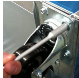
Schrauben Sie die Rollen in dieselben Löcher und überprüfen Sie, dass das Gerät waagrecht steht.
