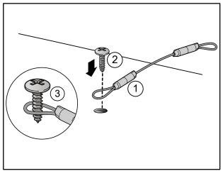
4. Drehen Sie die Schraube mit der Kabelschlaufe wieder in die Geräteabdeckung hinein.
