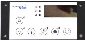
Jede Steuerung besteht aus dem Display (Bedienteil) und der Leistungselektronik (Platine), die im Steuergehäuse eingebaut ist. Das Display ist intern durch ein Kabel mit der Leistungselektronik verbunden. Das Bedienteil ist abnehmbar und kann in der Möbelfront montiert werden.
