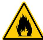
Dieses Symbol weist darauf hin, dass das im Inneren der Maschinenanlage enthaltene Kältemittel entzündlich ist und daher im Fall der Beschädigung der Anlage oder der Leitungen und während der Wartung besondere Aufmerksamkeit geboten ist.
