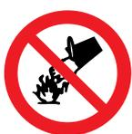
Dieses Symbol weist auf die Unmöglichkeit hin, Wasser, Nass- oder Schaumlöscher zum Löschen von Bränden auf elektrischen Geräten zu verwenden.
