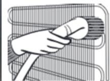
Abbildung 15: Kondensator reinigen
